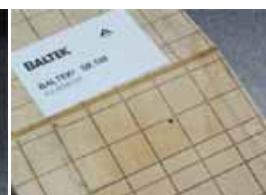
BALTEK® SB.100GPS (Version pour infusion) Panneaux poncés. Perforation (diamètre 2mm, 50 mm distance) et rainures (0.7 mm largeur, 2.5 mm profondeur).
