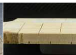
BALTEK® SB.100GPS (Version pour infusion) Panneaux poncés. Perforation (diamètre 2mm, 50 mm distance) et rainures (0.7 mm largeur, 2.5 mm profondeur).
