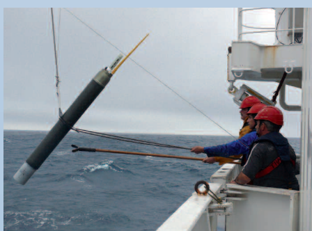
Mise à l'eau d'un flotteur autonome Provor [campagne Ovide 2006]. © Ifremer
